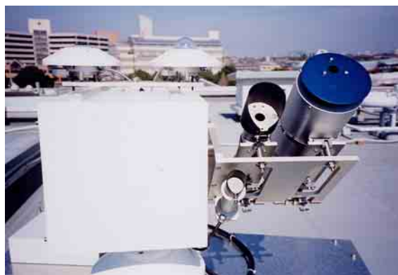
写真 太陽追尾装置全景 写真 太陽追尾装置搭載のセンサー類
